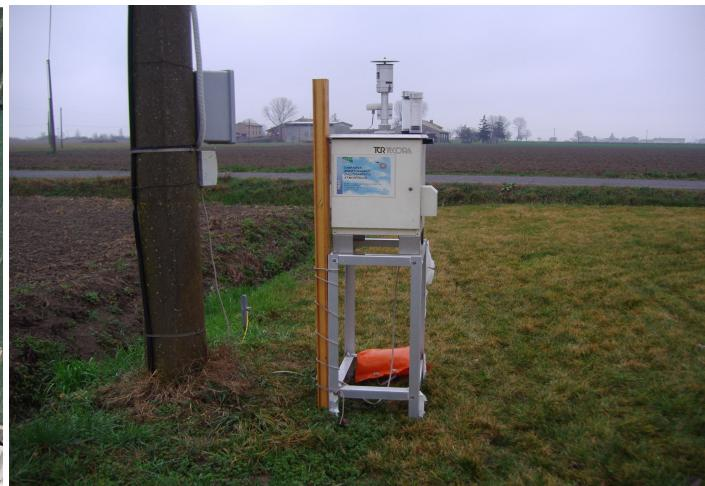
Le misure sono state effettuate nel sito indicato mediante strumentazione automatica in grado di garantire la rilevazione del valore medio di PM10 sulle 24 ore.
